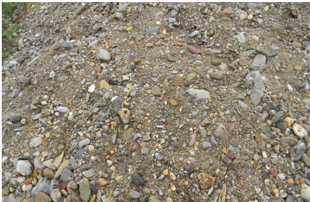
Slika 16. Rastresiti konglomerat Ravne (klasti s grubim krečnjačkim pijeskom kao osnovom). Ovaj materijal je korišten za blokiranje prolaza kroz kompleks tunela „Ravne“.
